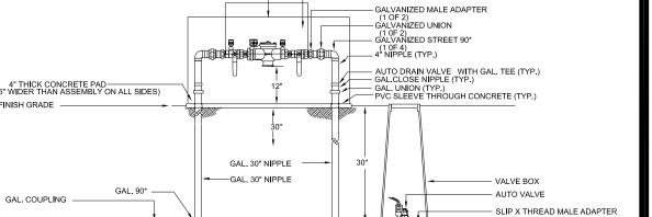
NOTE: 1. INSTALL BACKFLOW PREVENTER AS REQUIRED BY LOCAL CODES AND HEALTH DEPARTMENT. VERIFY LOCAL REQUIREMENTS PRIOR TO INSTALLATION.
