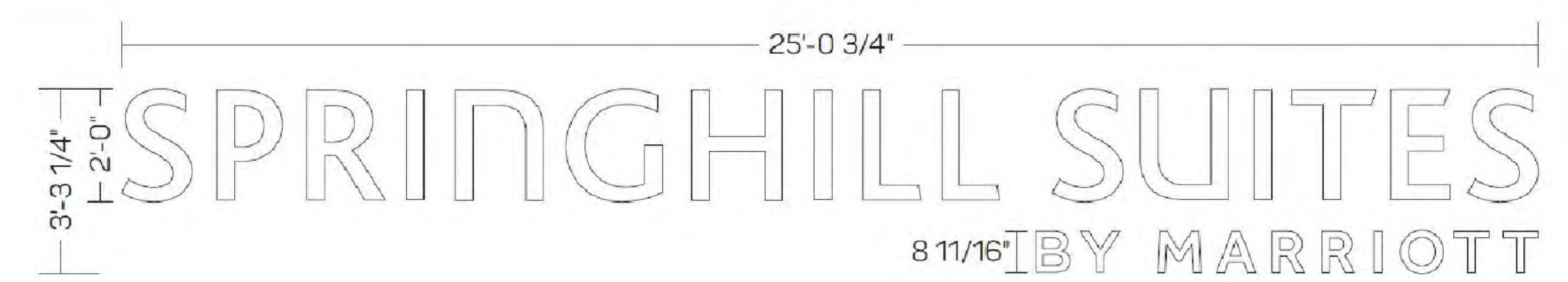
A1 SIGNAGE DETAIL 1 SCALE: 1/2" = 1'-0"
