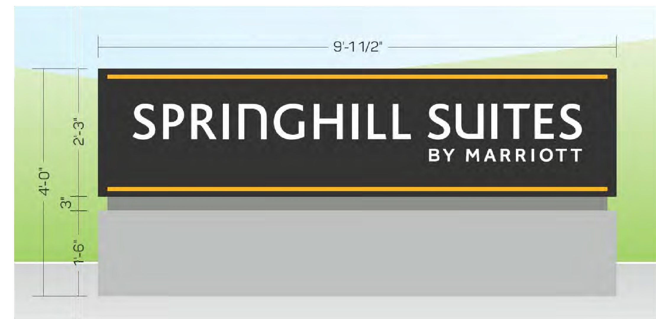
B1 SIGNAGE DETAIL 3 SCALE: 1" = 1'-0"
