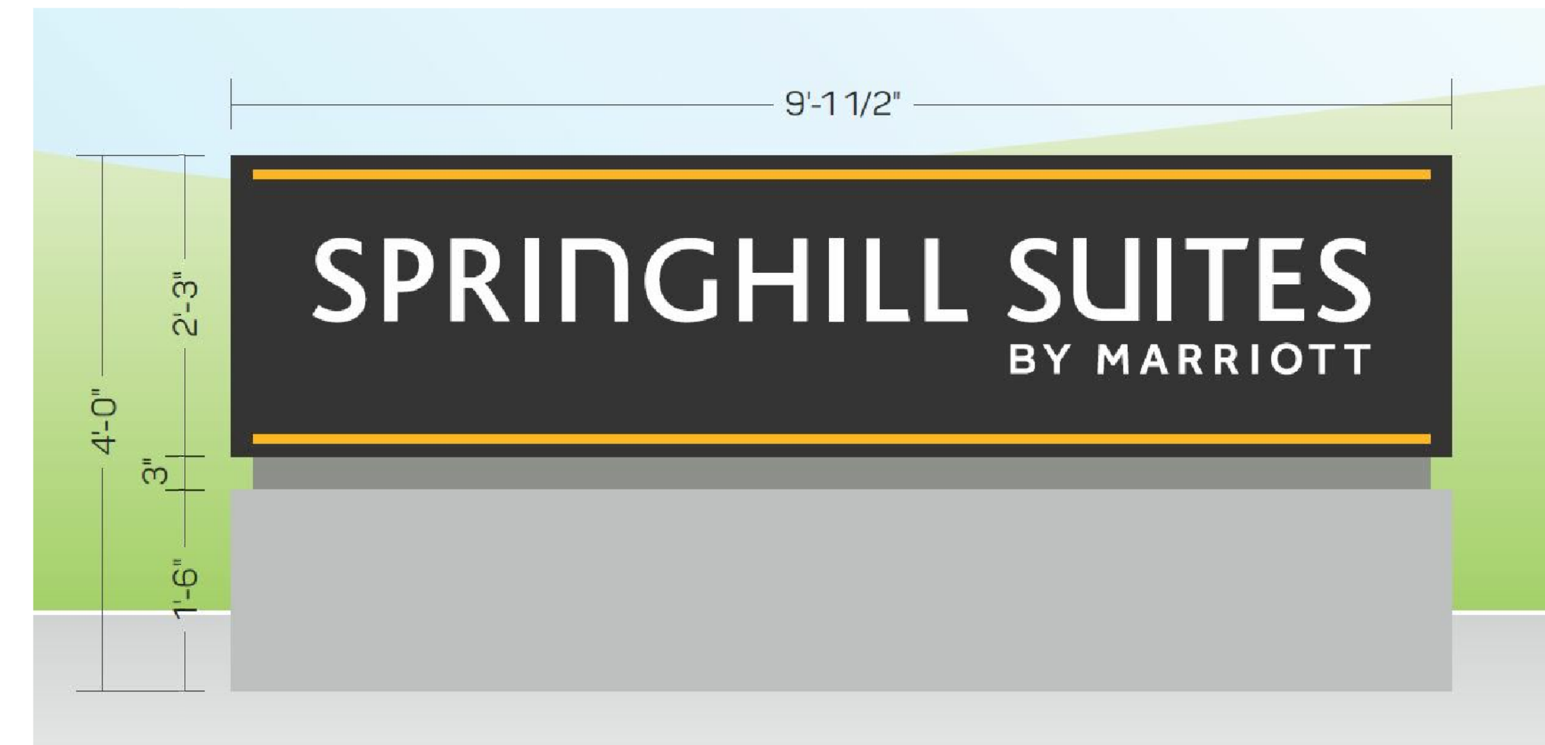
B1 SIGNAGE DETAIL 3 SCALE: 1" = 1'-0"
