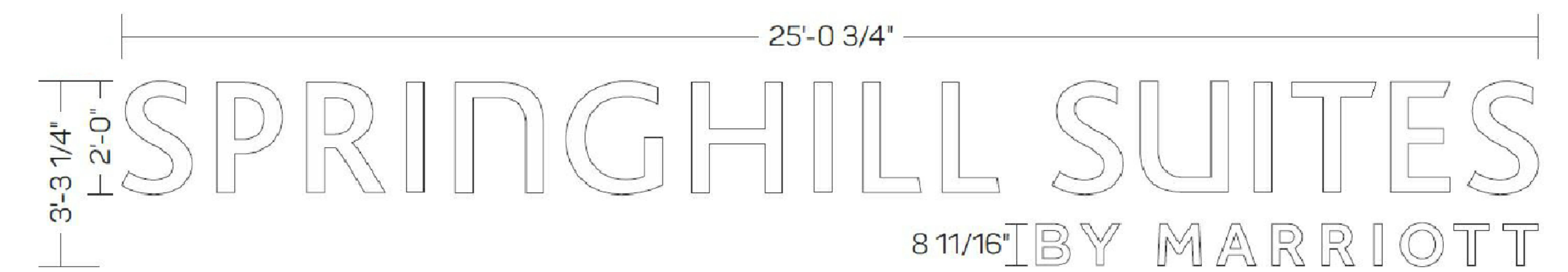
A1 SIGNAGE DETAIL 1 SCALE: 1/2" = 1'-0"
