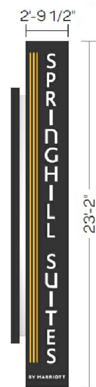
A3 SIGNAGE DETAIL 2 SCALE: 1/4" = 1'-0"
