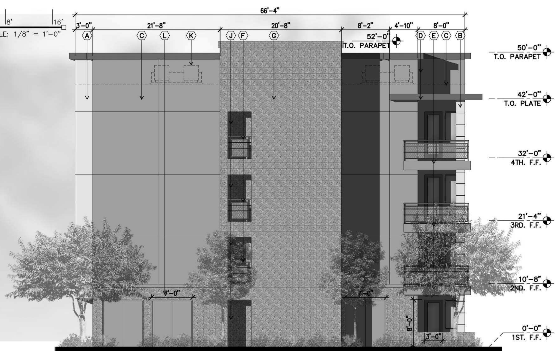
BLDG. TYPE 2 RIGHT ELEVATION
