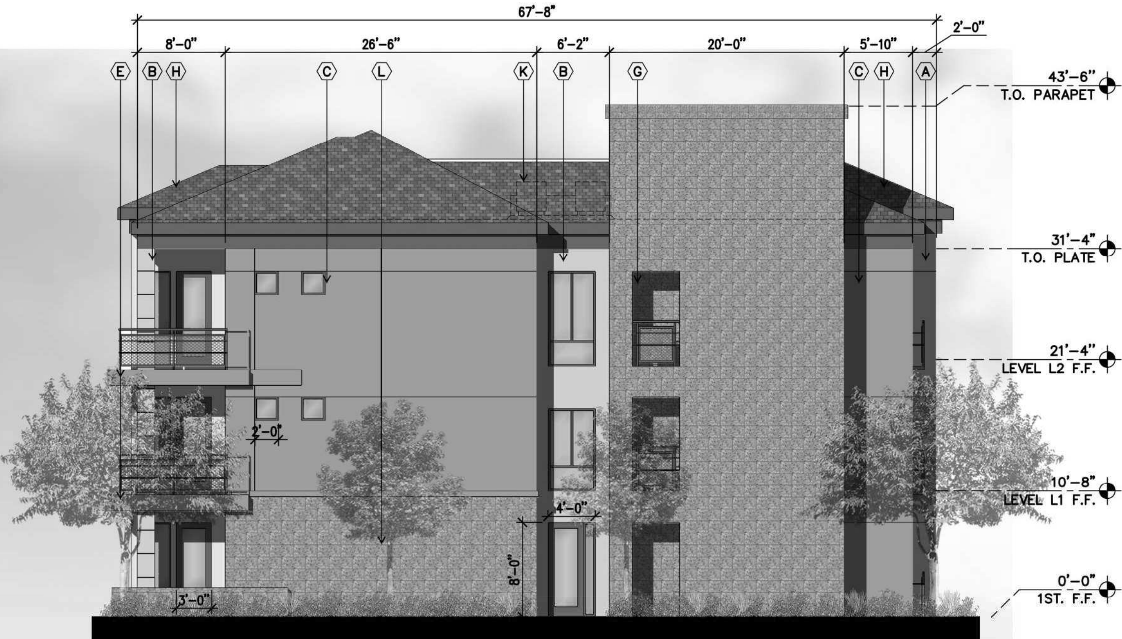
BLDG. TYPE 1 LEFT ELEVATION
