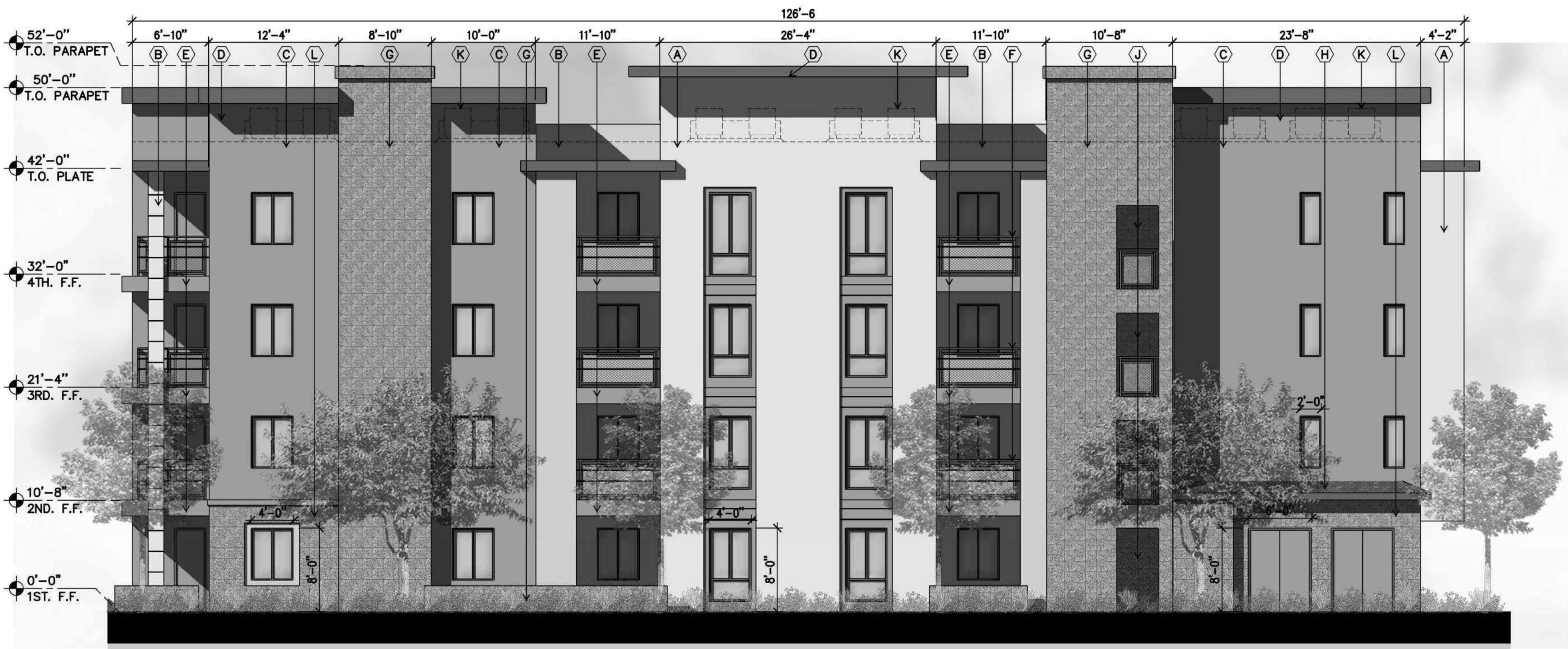
BLDG. TYPE 3 RIGHT ELEVATION
