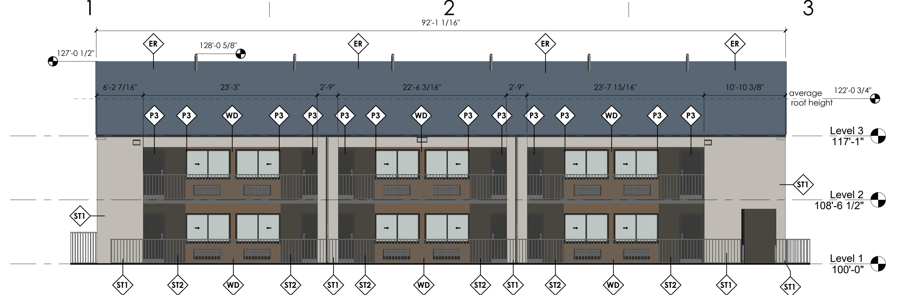
D1 BLDG G - ELEVATION - WEST 1/8" = 1'-0" SCALE: 1/8" = 1'-0"
