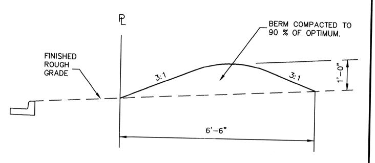
EROSION CONTROL BERM DETAIL
