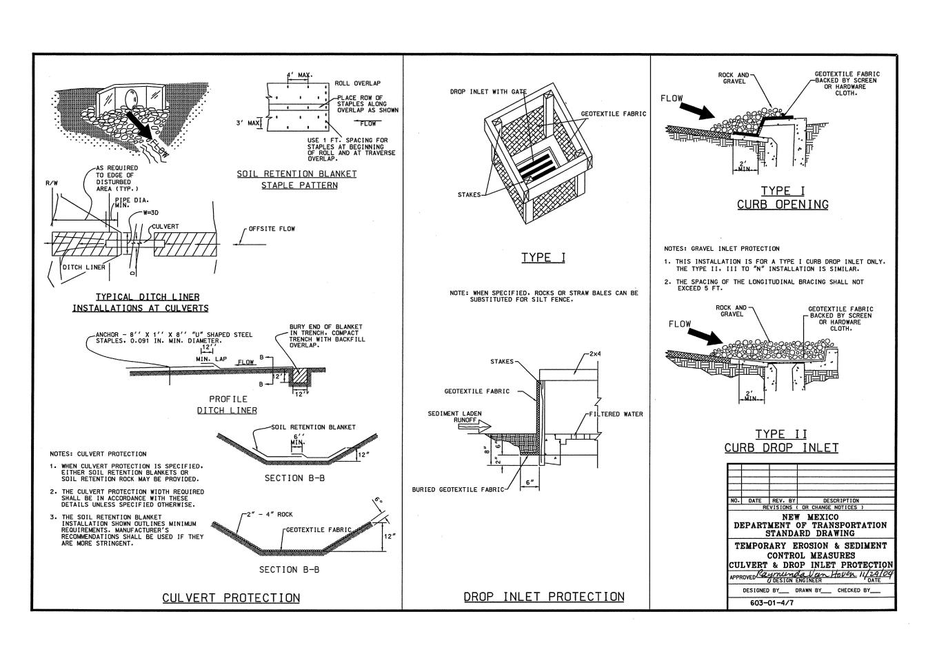
EROSION SEDIMENT CONTROL MEASURES DETAILS
