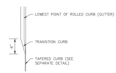
TAPERED CURB TRANSITION TO ROLLED CURB NO SCALE
