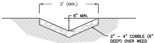
**COBBLE DRAINAGE SWALE DETAIL**
