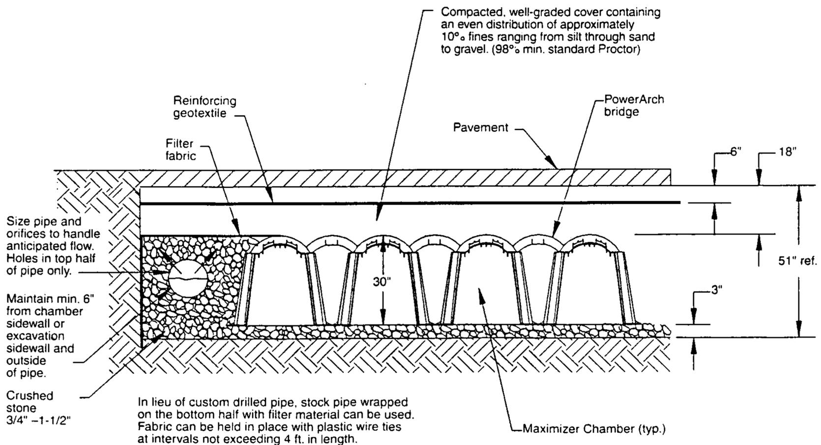
**PLAN VIEW OF THE MAXIMIZER CHAMBER SYSTEM**
