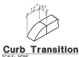
Curb Transition SCALE: NONE
