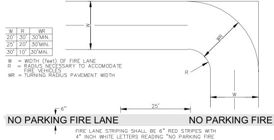
LANE" STRIPING SHALL BE PLACED ON THE TOP EDGE OF THE SIDEWALK ABUTTING THE PAVED DRIVE OR AS SPECIFIED BY LOCAL REQUIREMENTS. NO PARKING FIRE NO PARKING FIRE LANE
