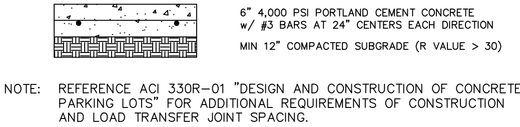
Concrete Pavement Section N.T.S.
