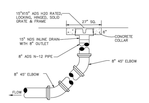
ADS NYLOPLAST INLINE DRAIN
